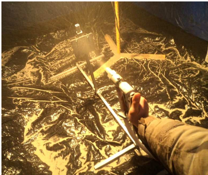
2. att. Parauga apsmidzināšana ar smilšu strūkļu
