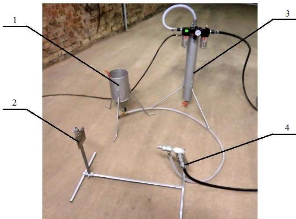
1. att. Smilšu strūklas sistēma pārklājumu noturības testam:
