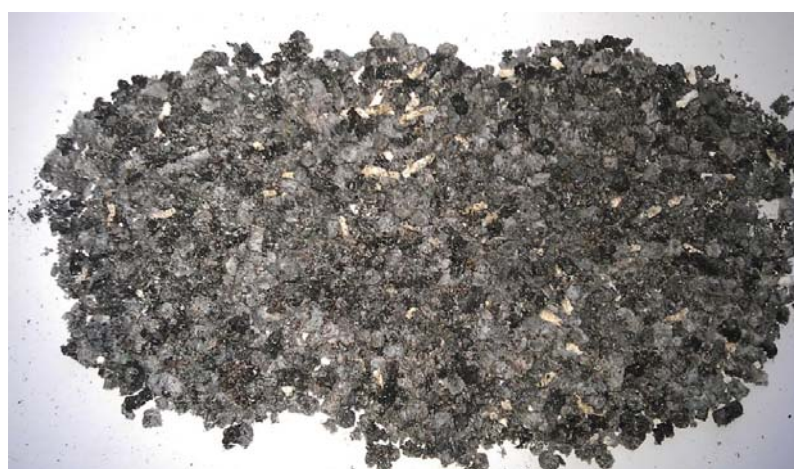
5. att. Kviešu salmu granulu pelni ar 1% katalizatora piejaukumu
