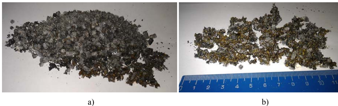
2. att. Kviešu salmu granulu pelni : a – kopējais pelnu daudzums; b - kristalizējušies pelni
