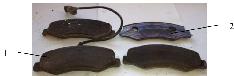
1. att. Nolietots bremžu uzliku komplekts, Renault Master III:
