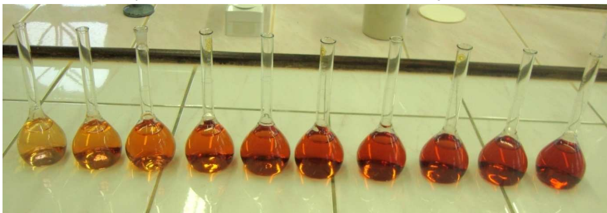
4. att. \text{Fe}^{3+} standartšķīdumi ( \text{Fe}^{3+} koncentrācija 0.1 – 1.0 \text{ mg} \cdot \text{dm}^{-3} (no kreisās uz labo pusi))
