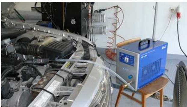
2. att. EP – 130 ūdeņraža ieguves iekārta pieslēgta testējamajam automobilim
