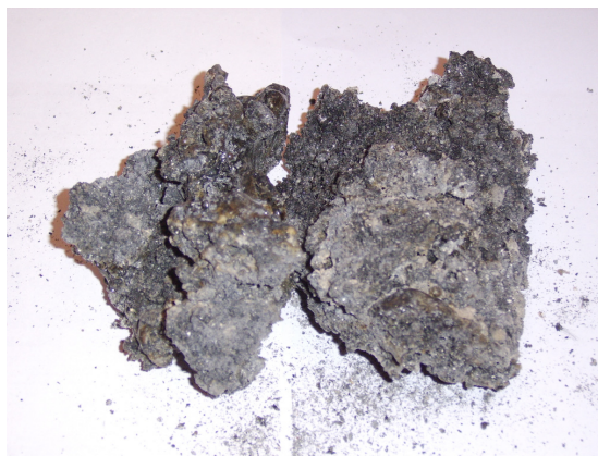
2. att. Izkusušo salmu granulu izdedži bez pievienotās pildvielas
