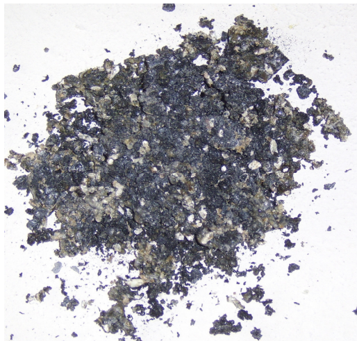
3. att. Salmu granulu izdedži ar 10% pildvielas piejaukumu no dedzināmās salmu granulu masas
