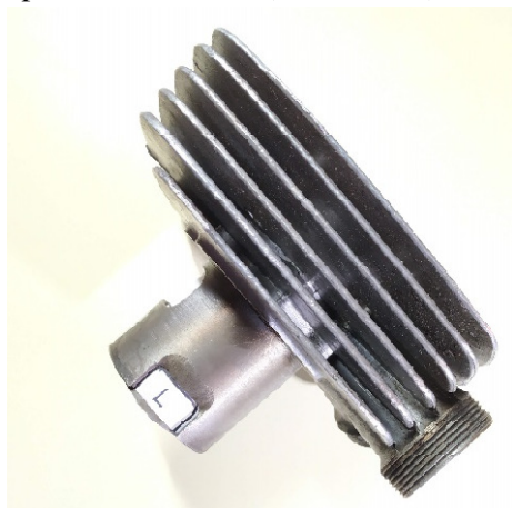
1. att. Cilindra ieplūdes un pārplūdes lūku izmēru noteikšana izmantojot iezīmēšanas metodi
