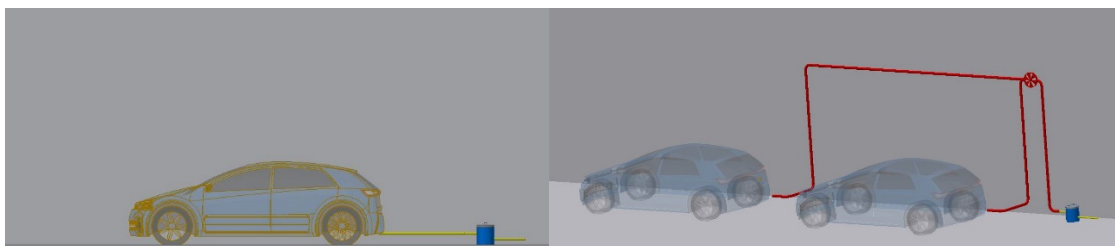
2. att. Principiālā shēma neitralizējot CO 2 no transportlīdzekļu izplūdes un toksisko izmešu sistēmas
