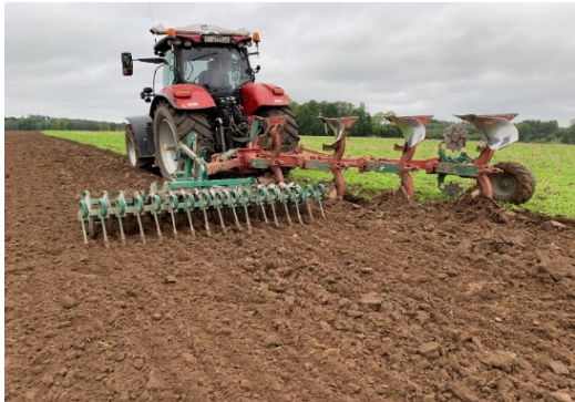
2. att. Traktors Case IH Puma 240 CVX ar četru korpusu maiņvērsējarklu Kverneland ES 100 un veltni Packomat S
