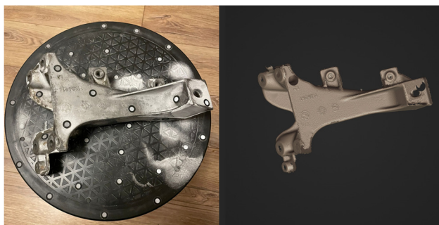
1. att. Skenēšanas process un neapstrādāts punktu mākonis
