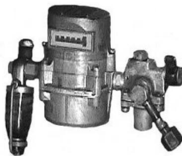
Fig. 1. Flow meter Adast Js6 8500.06 [6]
