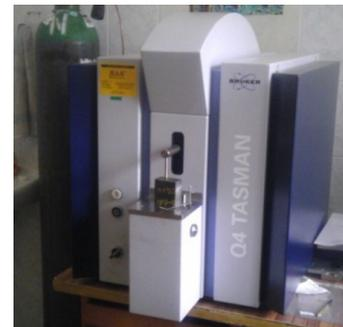
Fig. 8. Spectrometer BRUKER Q4 TASMAN
