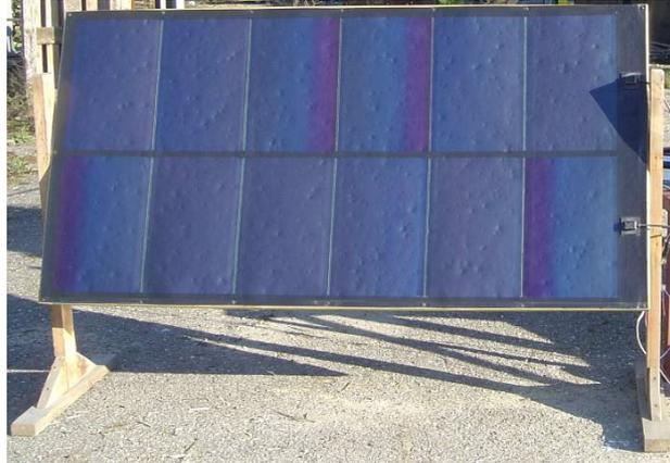
Fig. 4. 97 W flexible PV module
